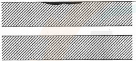
شکل و) تصویر LOF در کلیشه پرتونگاری Incomplete weld of groove
