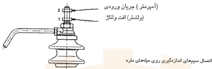
شکل (۷): محل اتصال تجهیزات اندازه گیری
