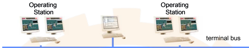
شکل (۲-۹) : Monitoring Level
