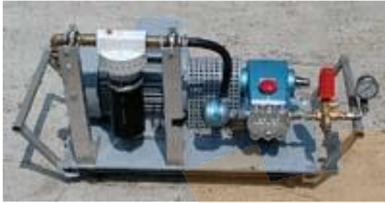
پمپ سیار نوع 310 تا 22 لیتر بر دقیقه
